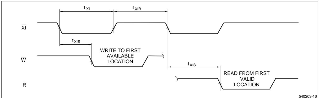
**Figure 21. Expansion-In Timing**
