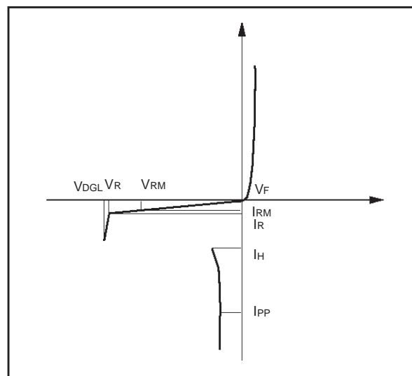
**PARAMETERS RELATED TO THE DIODE LINE / GND ( $T_{amb} = 25^\circ C$ )**
