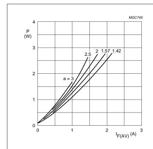
$a = I_{F(RMS)}/I_{F(AV)}; \ V_R = V_{RRMmax}; \ \delta = 0.5.$
