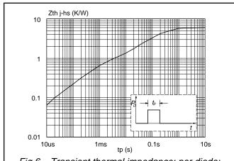
Fig.6. Transient thermal impedance; per diode;  $Z_{th j \cdot hs} = f(t_p)$ .
