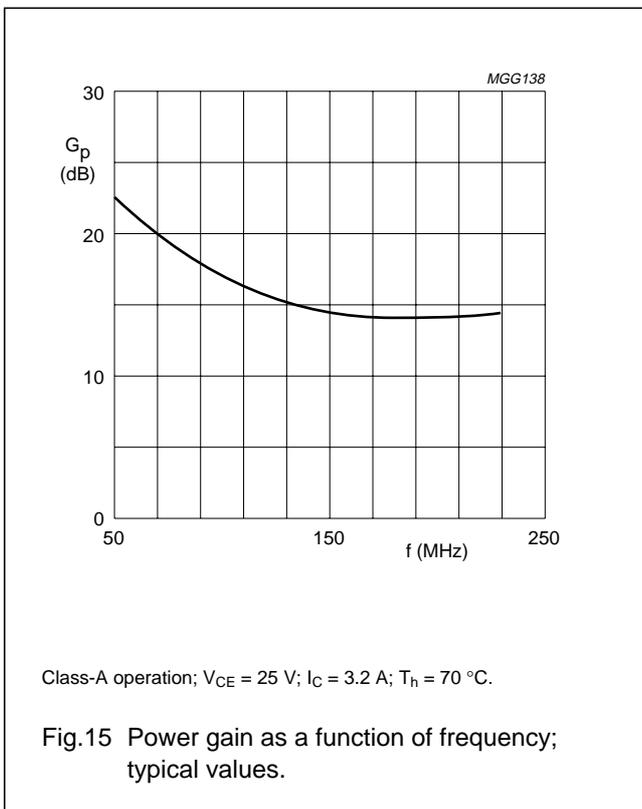
VHF linear power transistor
