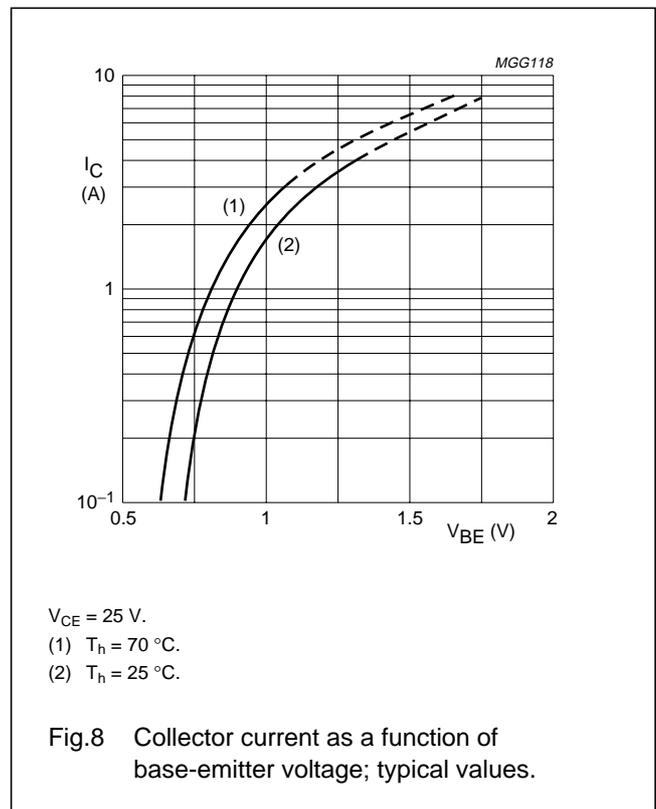
VHF linear power transistor
