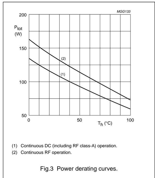
VHF linear power transistor
