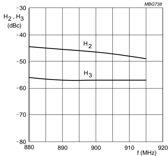
$Z_S = Z_L = 50 \Omega$ ;  $P_D = 3 \text{ dBm}$ ;  $V_S = 6 \text{ V}$ ;
