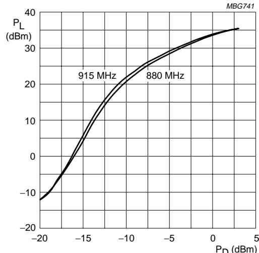
$Z_S = Z_L = 50 \Omega$ ;  $V_S = 6 \text{ V}$ ;  $P_L = 3.5 \text{ mW}$ ;
