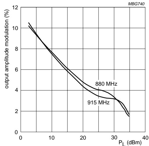
$Z_S = Z_L = 50 \Omega$ ;  $P_D = 3 \text{ dBm}$ ;  $V_S = 6 \text{ V}$ ;  $T_{mb} = 25^\circ\text{C}$ ;
