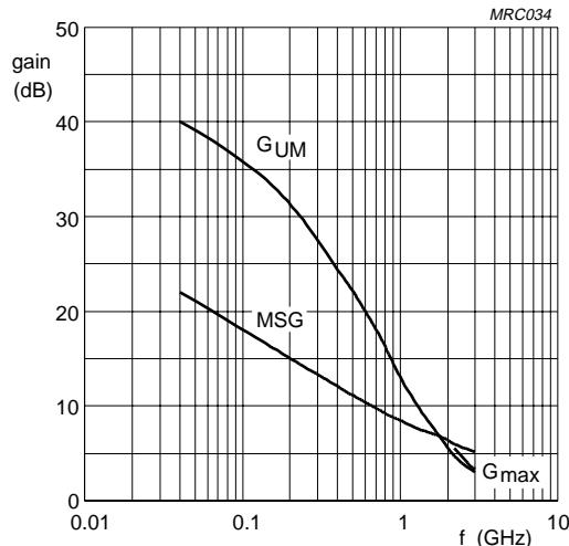
$I_C = 0.5 \text{ mA}$ ;  $V_{CE} = 1 \text{ V}$ ;  $T_{amb} = 25^\circ\text{C}$ .
