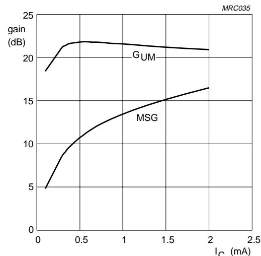
$V_{CE} = 1 \text{ V}$ ;  $f = 500 \text{ MHz}$ ;  $T_{amb} = 25^\circ\text{C}$ .
