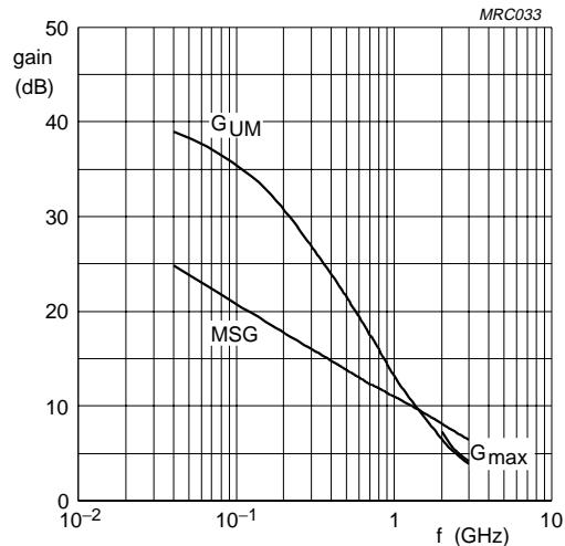
$I_C = 1 \text{ mA}$ ;  $V_{CE} = 1 \text{ V}$ ;  $T_{amb} = 25^\circ\text{C}$ .
