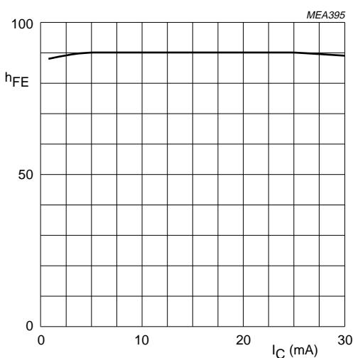
$V_{CE} = 1$  V;  $T_{amb} = 25$  °C.
