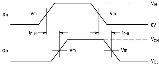
**WAVEFORM 4 - PROPAGATION DELAYS**
