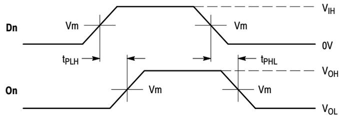
**WAVEFORM 1 - PROPAGATION DELAYS**
