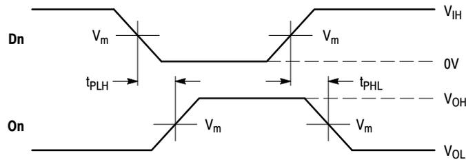
**WAVEFORM 3 - PROPAGATION DELAYS**
