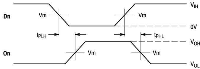
**WAVEFORM 1 - PROPAGATION DELAYS**
