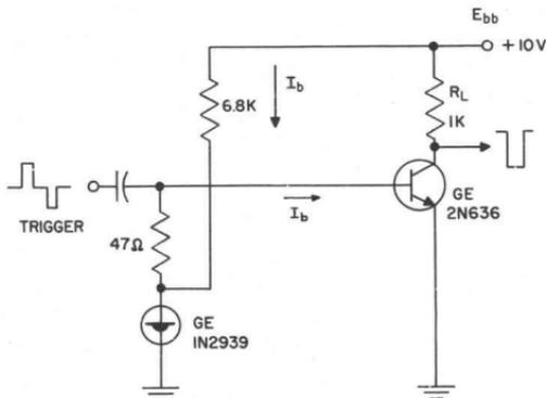
**BISTABLE CIRCUIT USING TUNNEL DIODE
