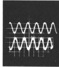
**100 Kc/s SINEWAVE OSCILLATOR CIRCUIT AND OUTPUT WAVEFORMS**
