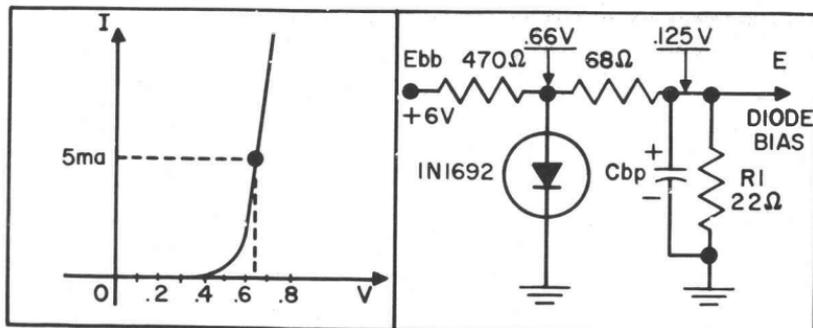
**SILICON DIODE VOLTAGE REGULATOR**
