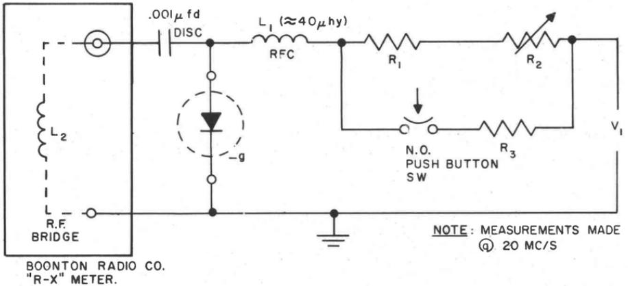
**BASIC TUNNEL DIODE CAPACITANCE TEST CIRCUIT**
