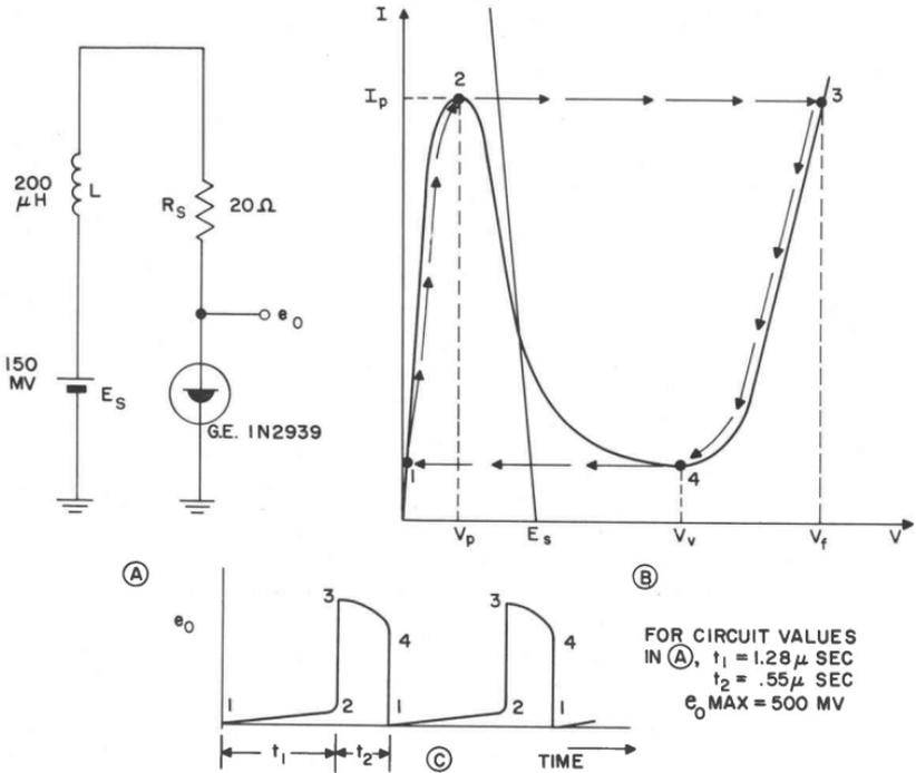
**BASIC TUNNEL DIODE RELAXATION OSCILLATOR CIRCUIT**
