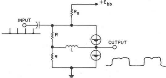
**TUNNEL DIODE FLIP-FLOP**
