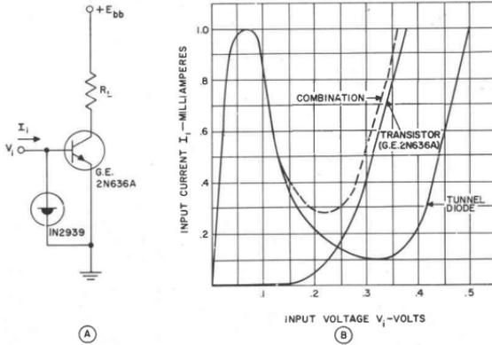
**HYBRID TRIGGER CIRCUIT AND CHARACTERISTIC**
