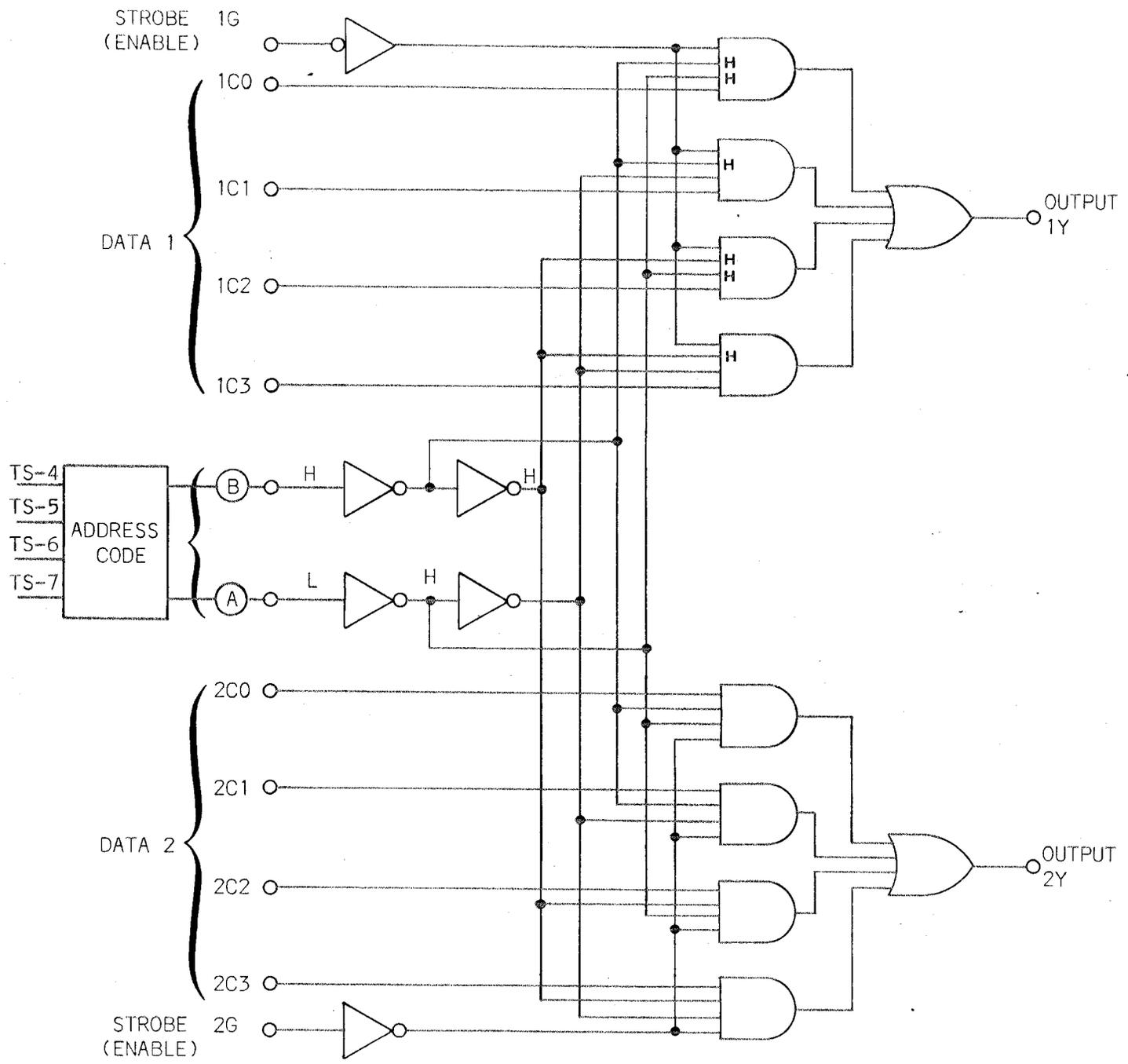
FIGURE 6 - 7D13 FUNCTIONAL BLOCK SN-74153
