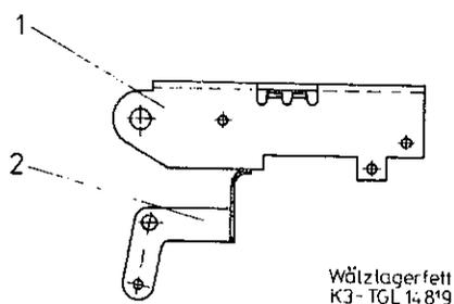
Bild 12 Schmierstellen an Kassettenträger und Schalthebel
