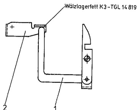
Bild 10 Schmierstellen am Schaltwinkel und Betätigungshebel
