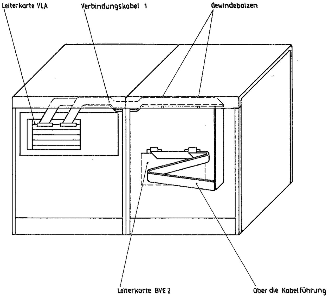
Bild 6 Verlegung der Verbindungskabel 1
