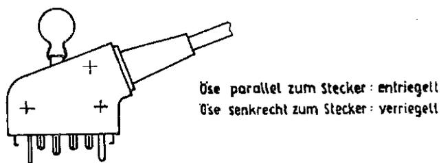
Bild 61 Informationskabel zur Vakuumerzeugung
