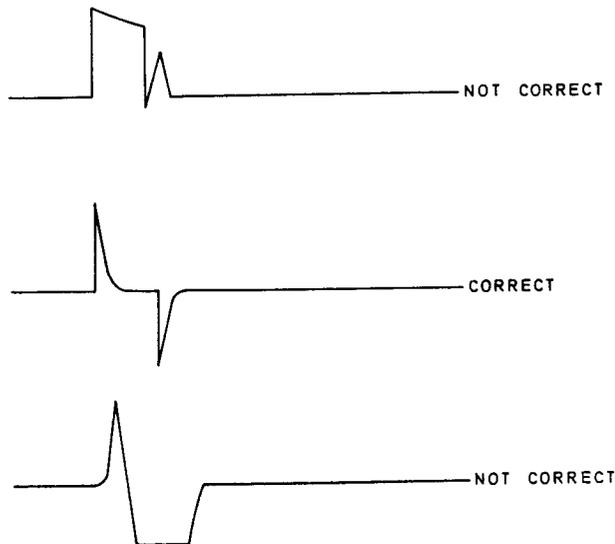
Test Waveform TP8 : 19-0822
