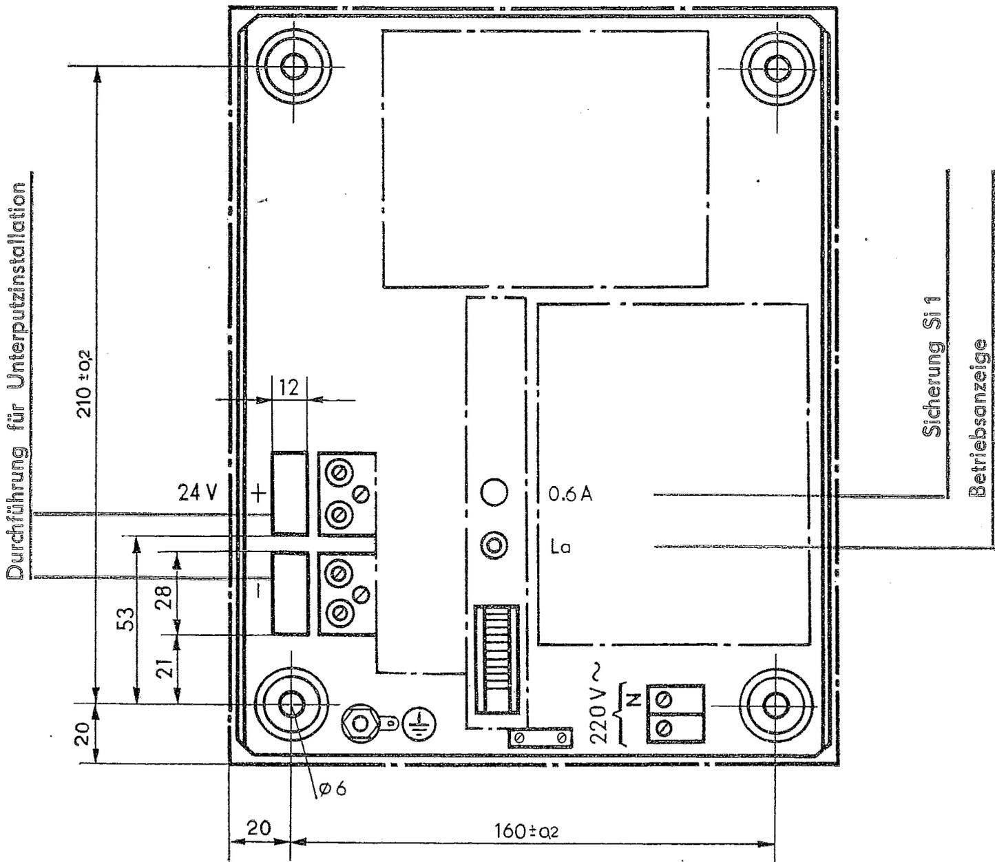
Die Gehäuse- und Montageabmessungen entsprechen denen des Wandgeräteeils der Sprechstellen WL 20 K 50 und WL 10 K 51.
