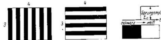
Bild 14 Balkenmuster auf dem Bildschirm eines Fernsehempfängers
