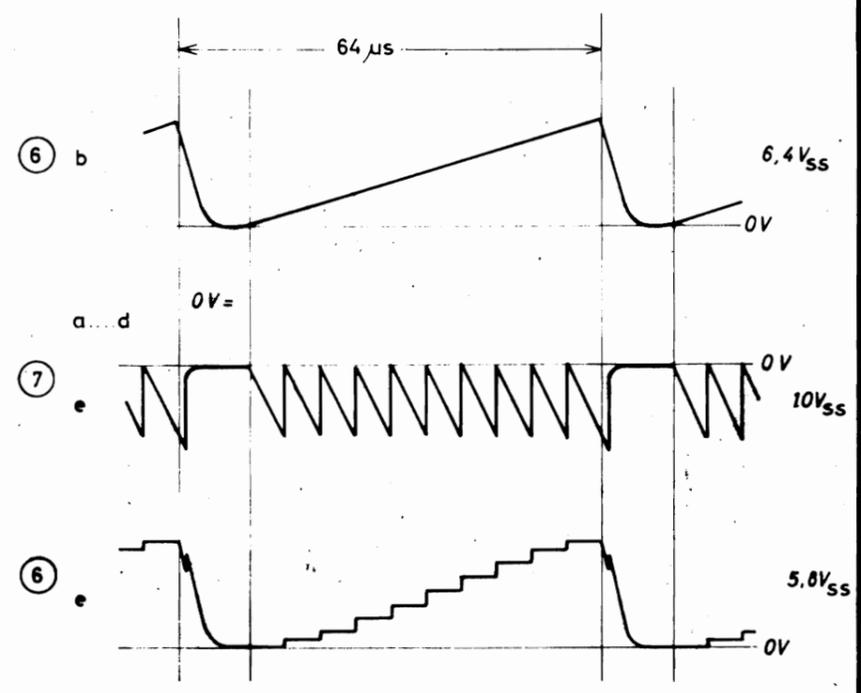
Oszillogramme gemessen mit Tastteiler,  $R_e=10M\Omega$ ,  $C_e\leq 10pF$
