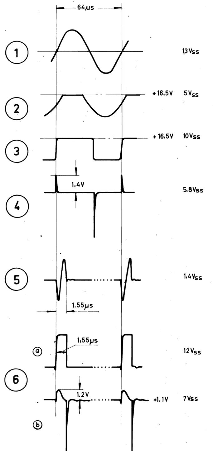
Oszillogramme gemessen mit Tastteiler  $R_e = 10\text{ M}\Omega$ ,  $C_e \leq 10\text{ pF}$
