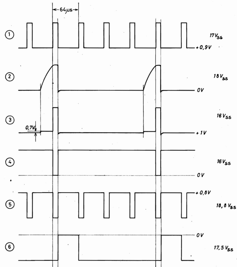
Oszillogramme gemessen mit Tastteiler;  $R_e = 10M\Omega$   $C_e \leq 10pF$
