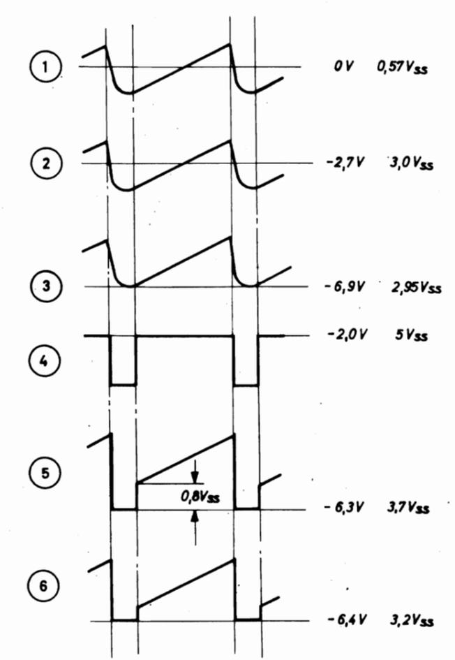
Oszillogramme gemessen mit Tastteiler  $R_e = 10M\Omega, C_e \leq 10pF$
