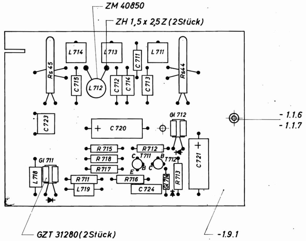
L 712 nach dem Tauchlöten montiert und gelötet nach HVM 230
