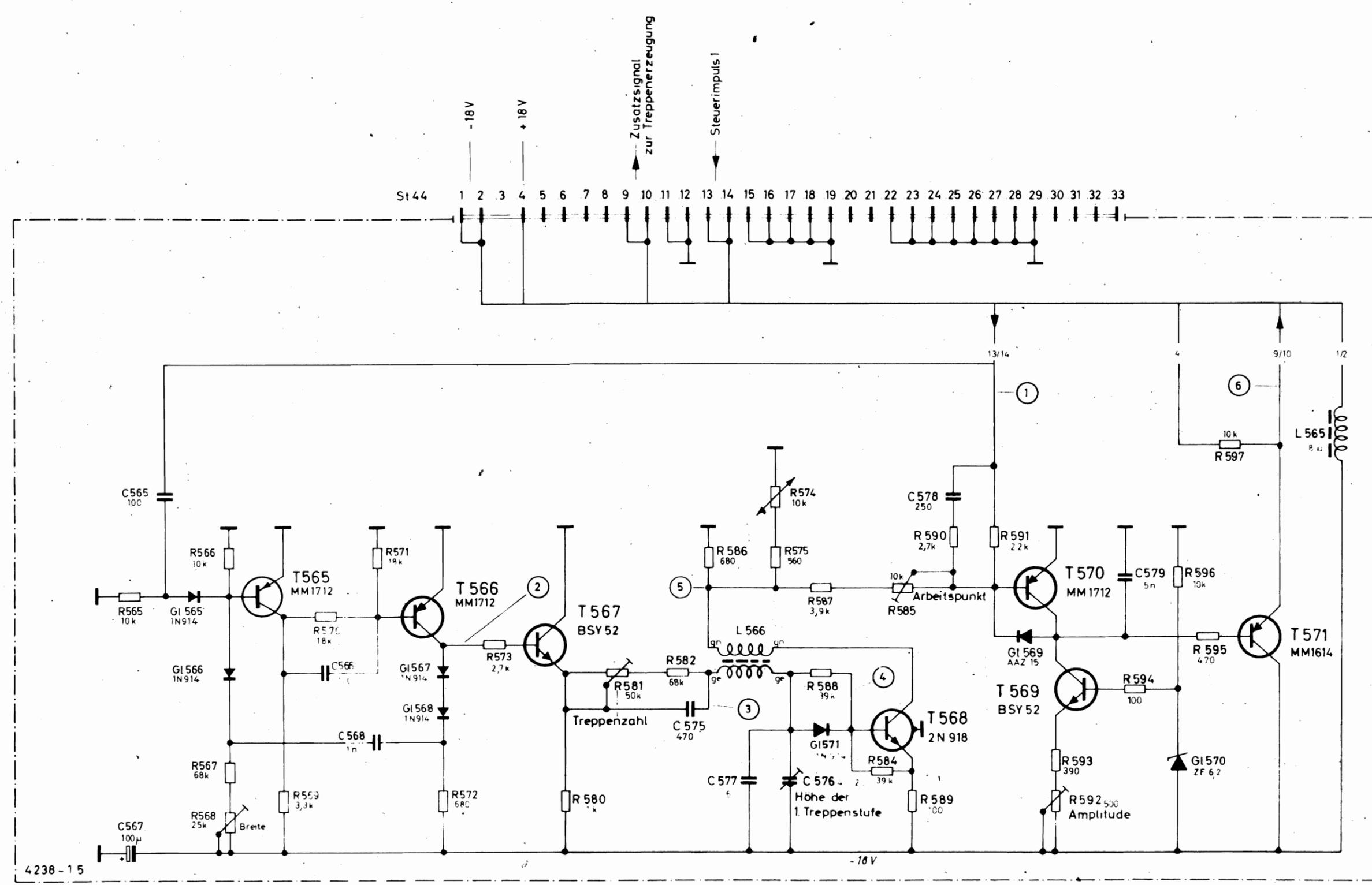
4238-15      Monostabiler Multivibrator      Trennstufe      Sperrschwinger      Sägezahnerzeugung      Trennstufe
