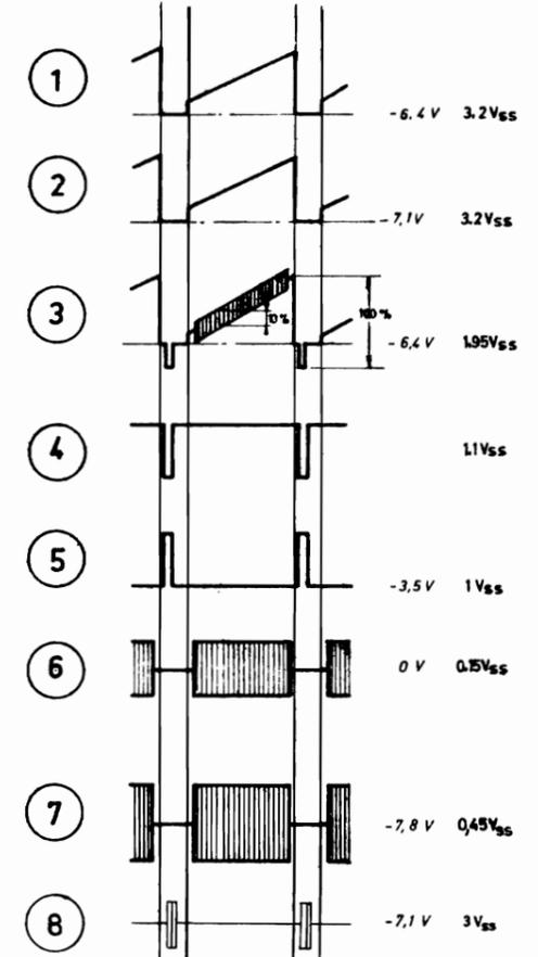
Oszillogramme gemessen mit Testleiter:  $R_e = 10\text{ M}\Omega$ ,  $C_e \leq 10\text{ pF}$
