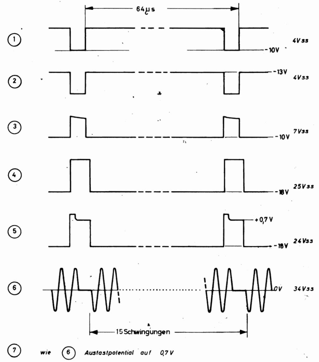
Oszillogramme gemessen mit Tastteiler  $R_e = 10M\Omega$ ,  $C_e \geq 10pF$
