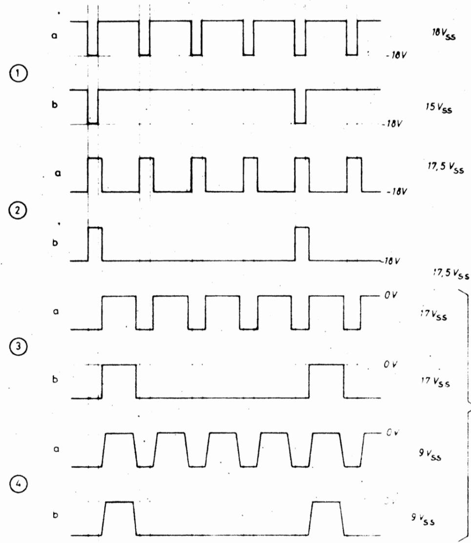
a: Bei Rechtecksignalen, Normalsägezahn und Treppe und bei Ruhestellung aller Tasten von S41 (kein B-Signal)
