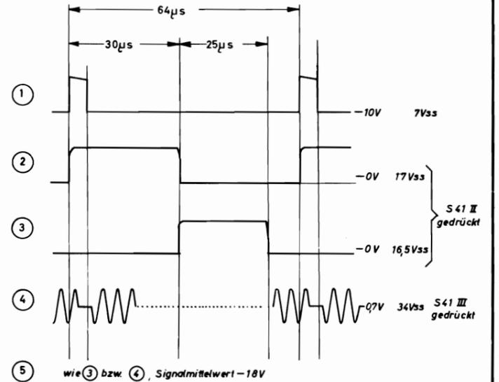
Oszillogramme gemessen mit Tastteiler  $R_p=10\text{M}\Omega$ ;  $C_p \geq 10\text{pF}$
