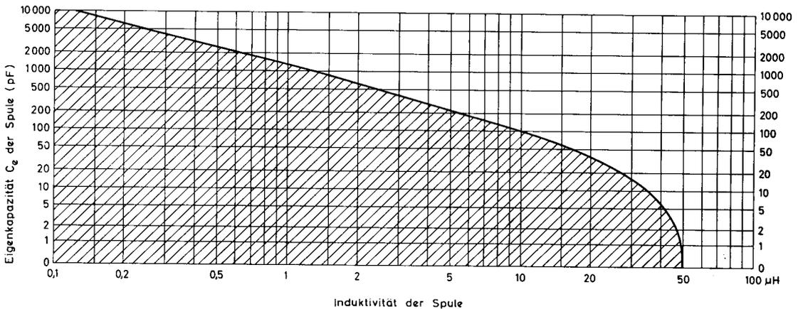
Bild 5. Untere Meßbereichgrenze für Eigenkapazitäten, abhängig vom L-Wert der Spule
