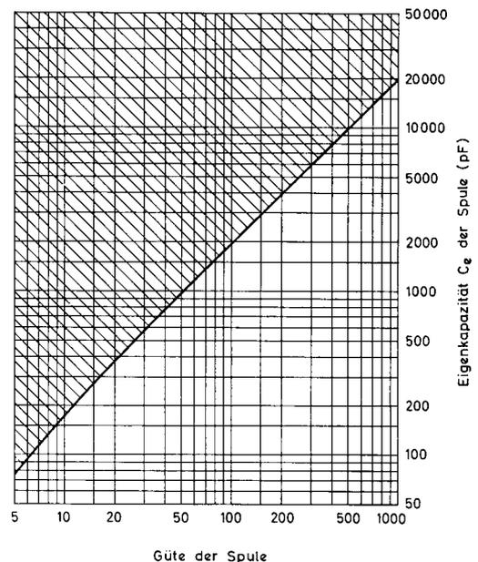
Bild 4. Obere Meßbereichgrenze für Eigenkapazitäten, abhängig von der Spulengüte
