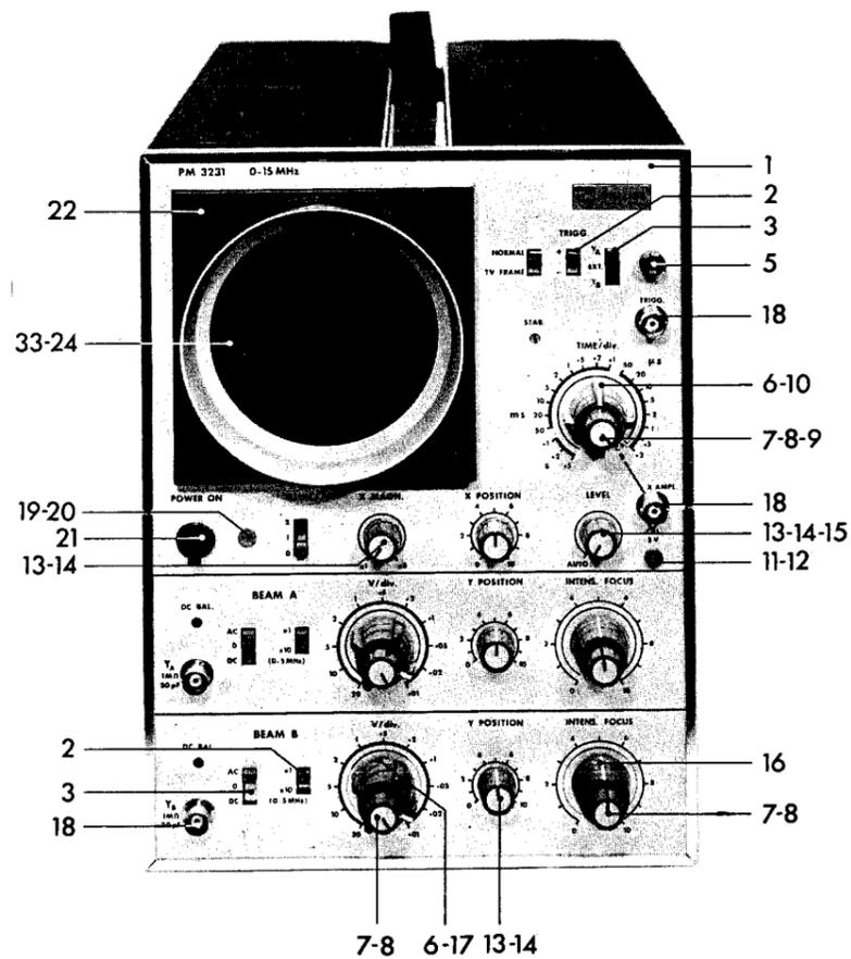
Abb. 22. Vorderseite mit Positionsnummern.
