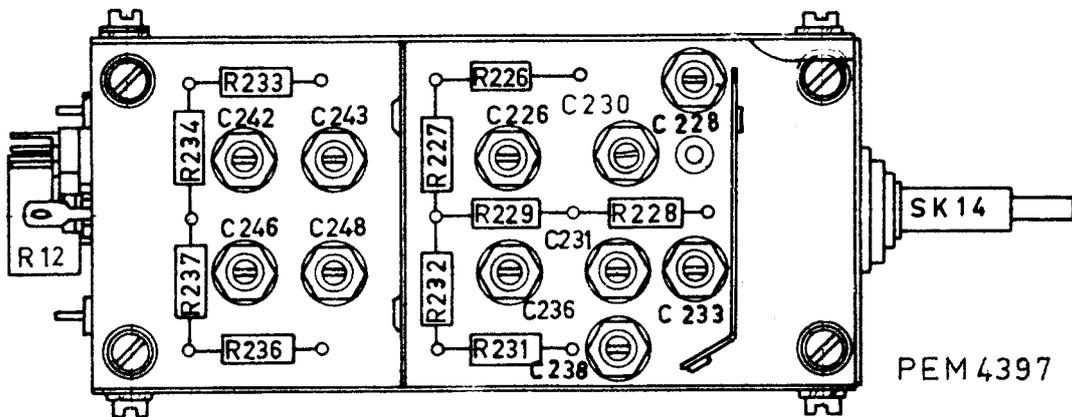
Abb. 26. Abschwächereinheit für Kanal B
