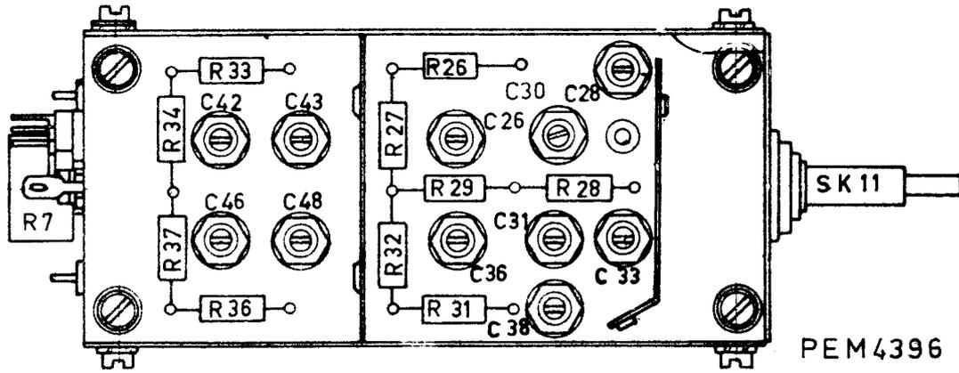
Abb. 25. Abschwächereinheit für Kanal A
