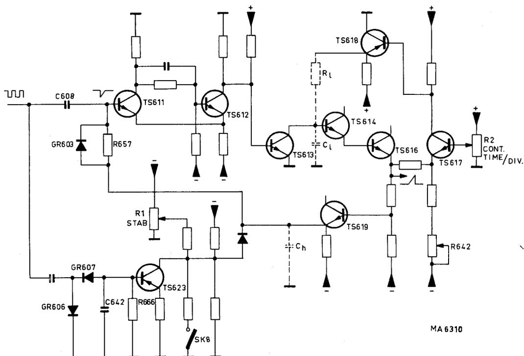
Abb. 6. Vereinfachtes Schaltbild des Zeitablenkgenerators
