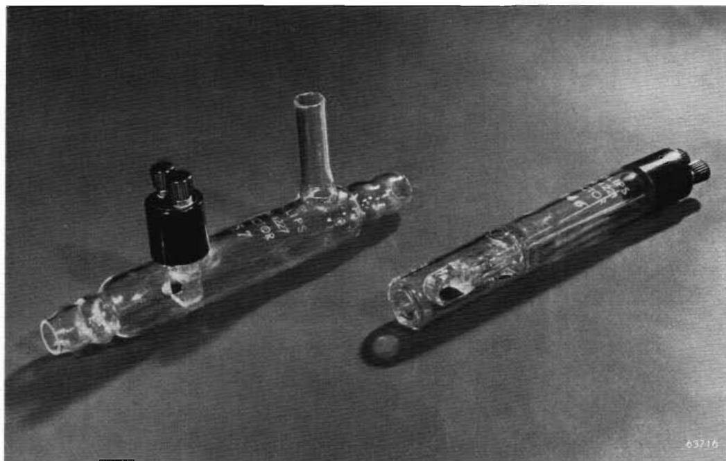
La cellule Philips à immersion GM 4221 et la cellule GM 4227 pour liquides en circulation, sont constituées par une paire d'électrodes en platine, recouvertes de noir de platine, pour éviter des phénomènes de polarisation. Elles permettent de déterminer la résistivité de la solution comprise entre les deux électrodes. La constante de cellule indiquée avec précision est comprise entre 1,20 et 2,00.
