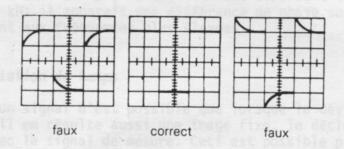
Le commutateur "TIMEBASE" doit en même temps se trouver en position "O,2ms/cm", et le couplage d'entrée Y commuté sur "DC". Le commutateur "Y-AMPL." étant sur la position la plus sensible, la hauteur du signal relevé est de 4cm. Etant donné qu'une sonde atténuatrice est constamment sollicitée mécaniquement et électriquement, l'ajustage devrait être contrôlé fréquemment.
