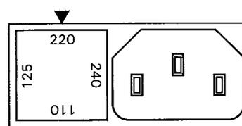
Sicherungstyp: Größe **5 x 20 mm**; 250 V~, C; IEC 127, Bl. III; DIN 41 662 (evtl. DIN 41 571, Bl. 3).
