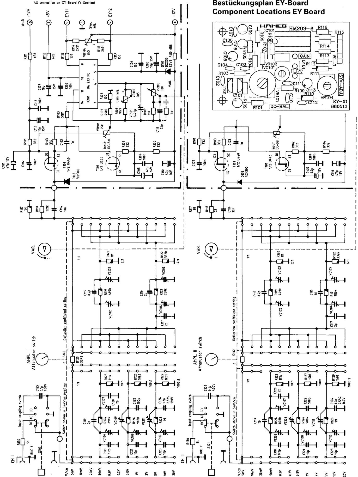
Y-Zwischenverstärker KI / KII, Kanalschaltung, Triggerverstärker, Komponententester HM205-2
