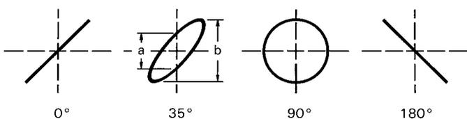
Die Berechnung des Phasenwinkels oder der Phasenverschiebung zwischen den X- und Y-Eingangsspannungen (nach Messung der Strecken **a** und **b** am Bildschirm) ist mit den folgenden Formeln und einem Taschenrechner mit Winkelfunktionen ganz einfach und übrigens **unabhängig von den Ablenksamplituden** auf dem Bildschirm.
