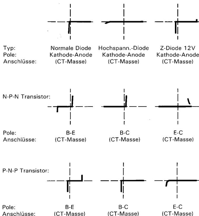
Zu beachten ist hier der Hinweis, daß die Anschlußumpolung eines Halbleiters (Vertauschen von CT-Buchse mit Masse-Buchse) eine Drehung des Testbilds um  $180^\circ$  um den Rastermittelpunkt der Bildröhre bewirkt.
