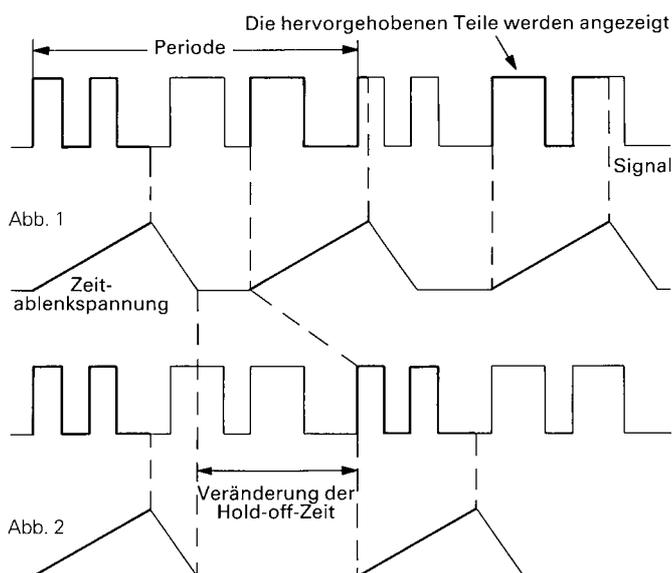
Abb. 1 zeigt das Schirmbild bei Linksanschlag des **HOLD-OFF**-Einstellknopfes (Grundstellung). Da verschiedene Teile des Kurvenzuges angezeigt werden, wird kein stehendes Bild dargestellt (Doppelschreiben).
