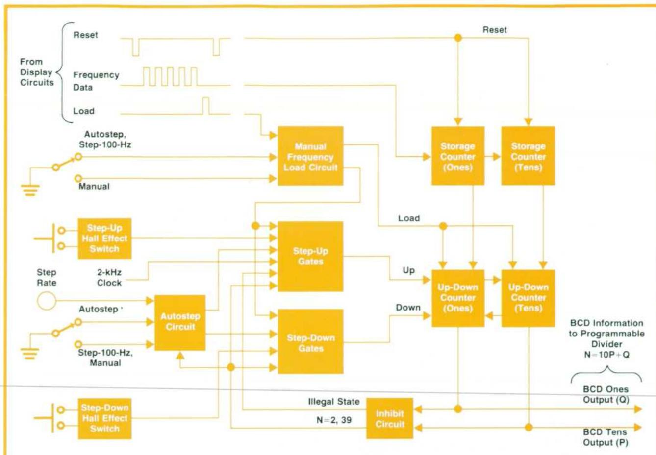
Fig. 3. Step-100-Hz circuit
