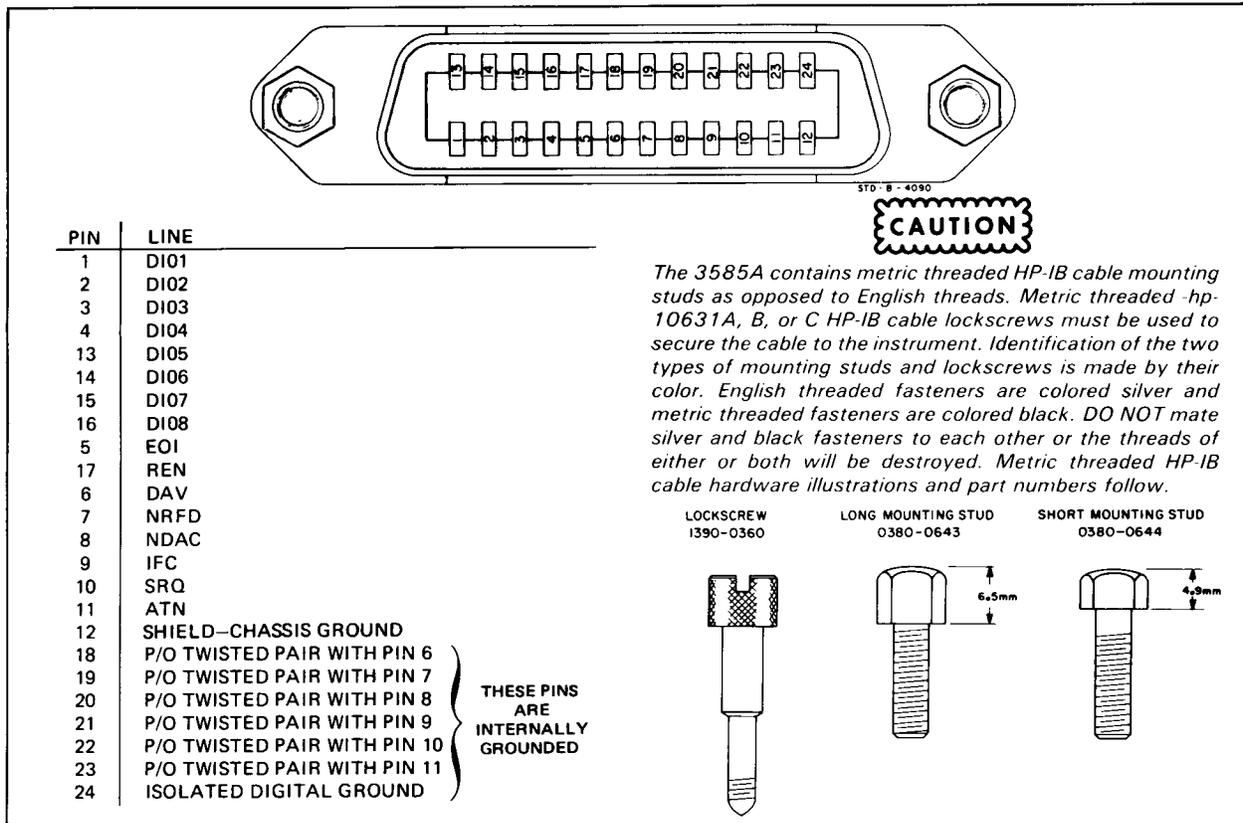
**Figure 2-5. HP-IB Connector**
