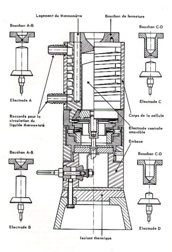
Fig. 26a - Cellule CS 601 avec ses 4 électrades et les bouchons correspondants.
