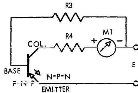
o) TRANSISTOR TEST 2 (Beta)
