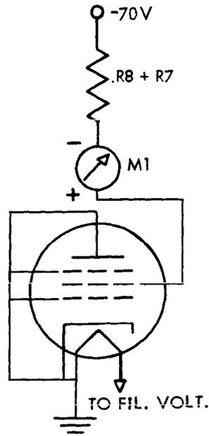
c) SCREEN-TO-ALL LEAKAGE TEST
