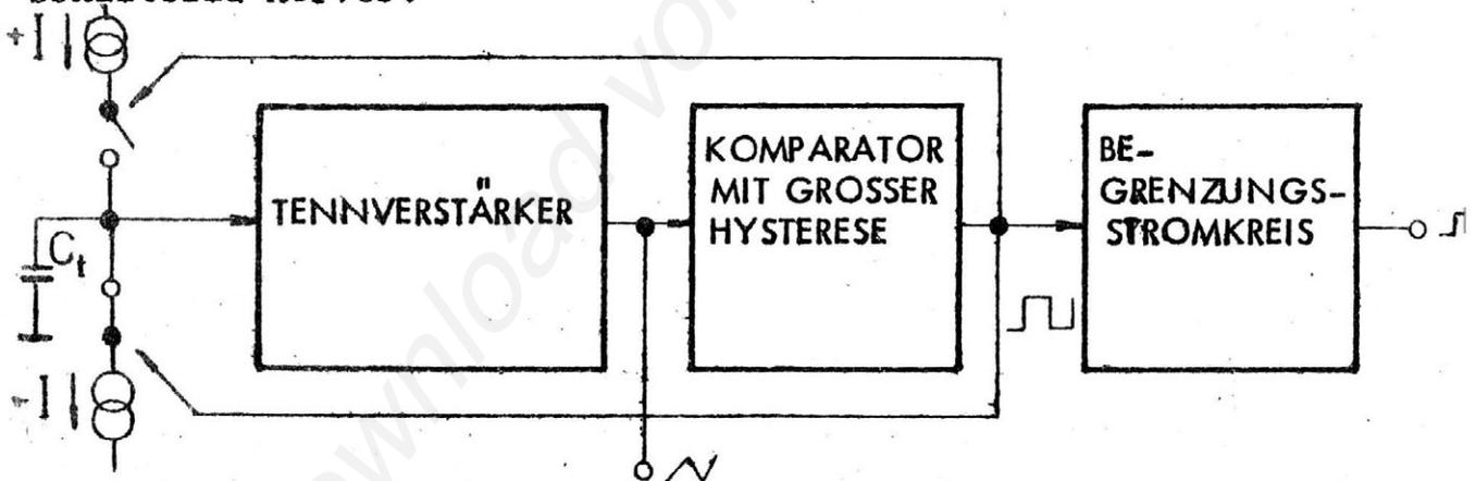
Beim Einschalten befindet sich der Ausgang des Komparators mit großer Hysterese in einem Zustand, in dem die Funktion z.B. des negativen Stromgenerators genehmigt wird. Demzufolge nimmt die Spannung am Kondensator  $C_T$  in negativer Richtung linear zu. Wenn die Spannung des negativen Komparationspegel des Komparators erreicht, kippt der Komparator und blockiert den den negativen Strom liefernden Stromgenerator und genehmigt zugleich
