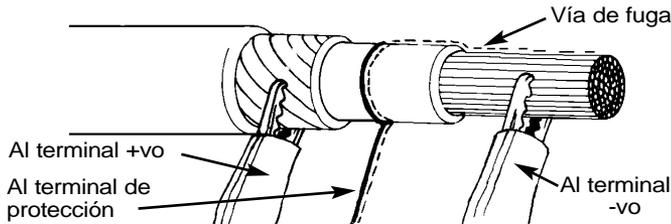
El terminal de protección está al mismo potencial que el terminal negativo. Desde que la resistencia de fuga es paralela efectiva con la resistencia a medirse, el uso de protección hace que la corriente que fluye a través de la fuga superficial se desvíe del circuito de medición. Por lo tanto, el instrumento lee la fuga del aislador, ignorando la fuga a través de su superficie.
