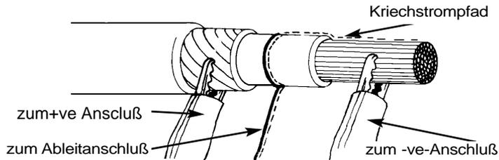
Der Schutzdrahtanschluß hat dasselbe Potential wie der Minusanschluß. Da der Kriechstromwiderstand effektiv parallel zu dem zu messenden Widerstand verläuft, bewirkt die Verwendung des Schutzdrahtanschlusses, daß der aufgrund von Oberflächenkriechströmen fließende Strom vom Meßschaltkreis abgelenkt wird. Das Instrument zeigt deshalb den Kriechstrom des Isolators an und ignoriert über seine Oberfläche verlaufende Kriechströme.
