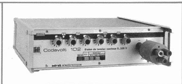
La particularité de cet appareil réside dans le procédé original de conversion "numérique/analogique" utilisé pour la génération de la tension continue (Voir, en particulier, la note d'application "Nouveaux générateurs de signaux électriques, programmables") (\*).
