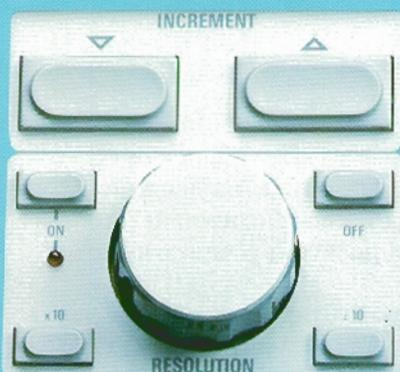
**ROUE CODEUSE** dont la validation facultative pour chaque paramètre permet l'entrée ou la correction analogique de la fréquence, du niveau de sortie, de la déviation FM ou ØM, du taux de modulation etc... La recherche de maxima ou minima, le balayage manuel avec positionnement optimal de marqueurs.
