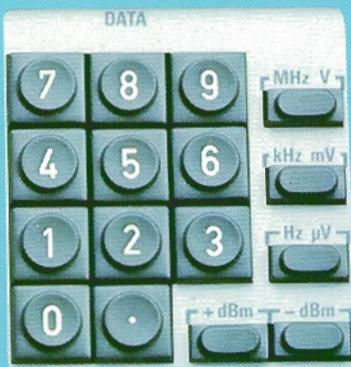
**ENTREE** numérique en virgule flottante de la fréquence RF en Hz, kHz, MHz, du niveau en dBm, Volts, mV,  $\mu V$  et dB/ $\mu V$ ; de la fréquence de modulation; de la déviation en FM, et ØM; du taux en AM.
