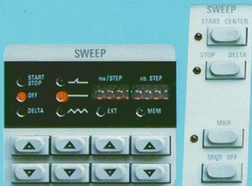
**BALAYAGE** mococoup (A) ou relaxé (M) de tous les paramètres Fréquence RF et AF, Niveaux, Modulations AM, FM, ØM entre deux limites définies "START"/"STOP", ou de part et d'autre "DELTA" d'une valeur centrale.
