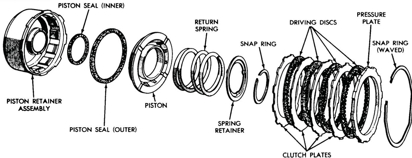
Fig. 13—Front Clutch
