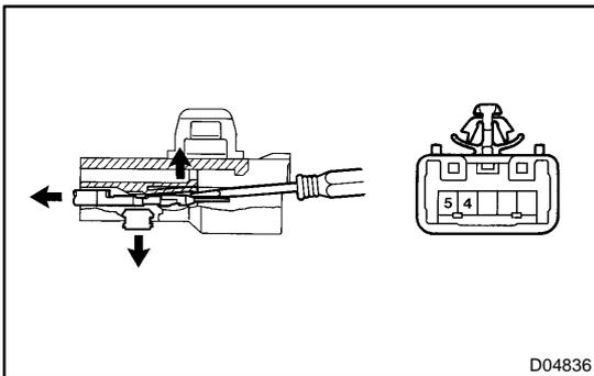
**7. DISCONNECT SHIFT LOCK CONTROL ECU, SHIFT LOCK SOLENOID, SHIFT LOCK CONTROL SWITCH AND TRANSMISSION CONTROL SWITCH**
