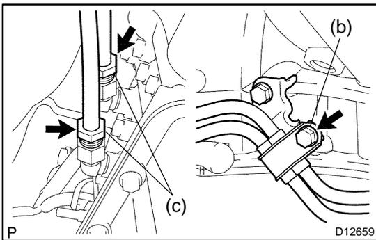
**12. DISCONNECT OIL COOLER PIPES**
