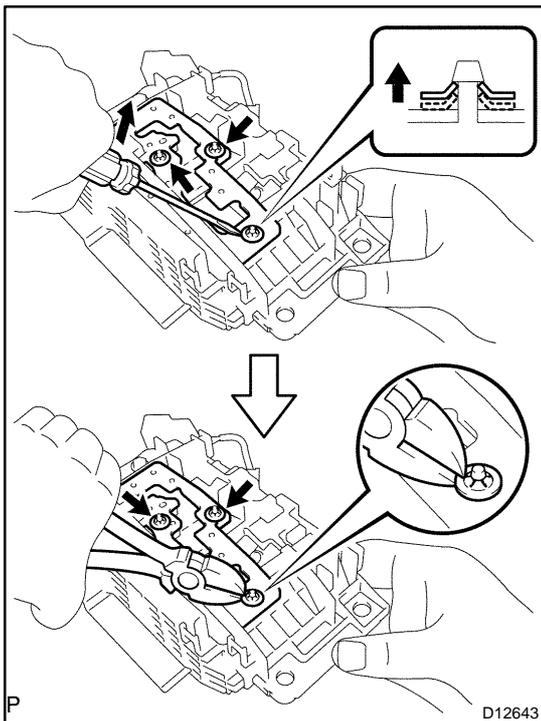
6. **DISASSEMBLE SHIFT LEVER GUIDE HOUSING**
