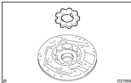
**15. INSTALL FRONT OIL PUMP DRIVE GEAR**
