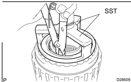
**29. INSTALL CLUTCH BALANCER NO.3**
