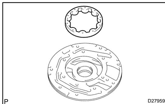
**14. INSTALL FRONT OIL PUMP DRIVEN GEAR**
