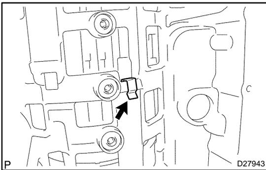
**85. INSTALL BRAKE PLATE STOPPER SPRING**
