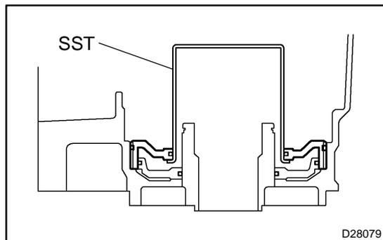
**75. REMOVE BRAKE REACTION SLEEVE**
