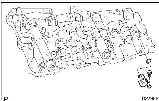
**9. INSTALL SHIFT SOLENOID VALVE S2**
