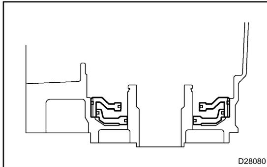
**79. INSTALL BRAKE REACTION SLEEVE**
