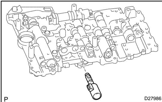
**6. REMOVE SHIFT SOLENOID VALVE SL1**
