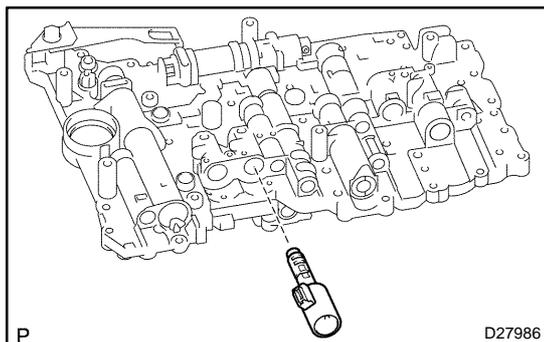
**11. INSTALL SHIFT SOLENOID VALVE SL1**
