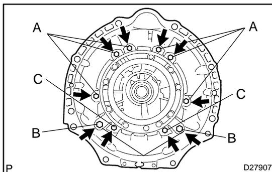
**132. INSTALL AUTOMATIC TRANSMISSION HOUSING**
