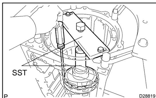
**94. INSTALL BRAKE PISTON RETURN SPRING SNAP RING**
