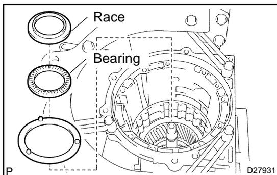
**98. INSTALL FRONT PLANETARY GEAR ASSY**
