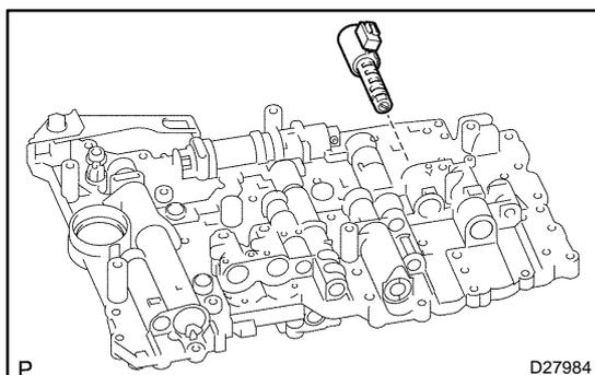
**13. INSTALL SHIFT SOLENOID VALVE SL2**
