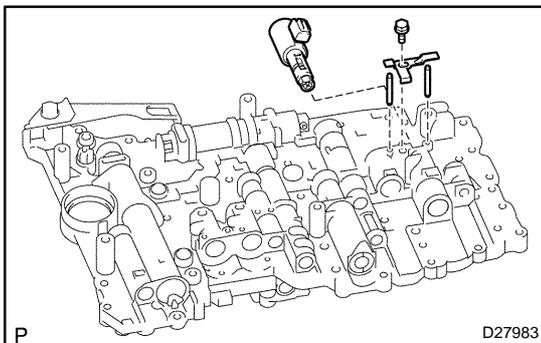
**3. REMOVE SHIFT SOLENOID VALVE SLU**
