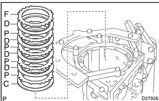
**104. INSTALL BRAKE DISC NO.3**
