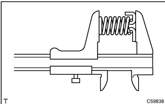
**25. INSPECT DIRECT CLUTCH RETURN SPRING SUB-ASSY**
