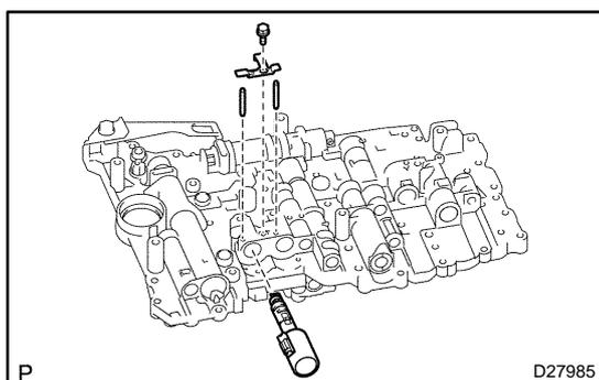
**12. INSTALL SHIFT SOLENOID VALVE SLT**
