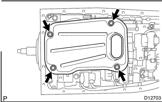
**17. REMOVE VALVE BODY OIL STRAINER ASSY**
