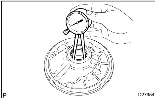
**6. INSPECT FRONT OIL PUMP BODY SUB-ASSY**
