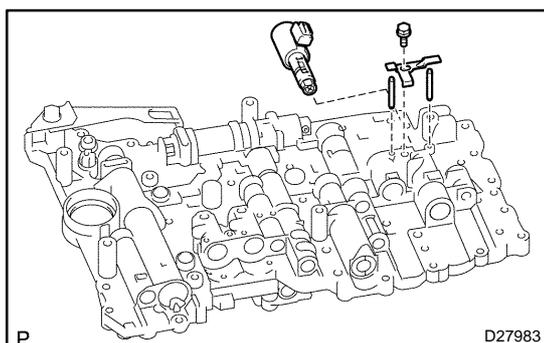
**14. INSTALL SHIFT SOLENOID VALVE SLU**
