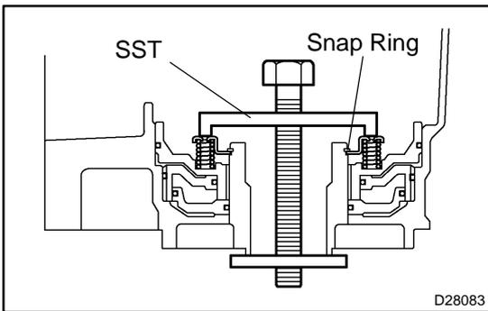
**72. REMOVE 1ST & REVERSE BRAKE RETURN SPRING SUB-ASSY**
