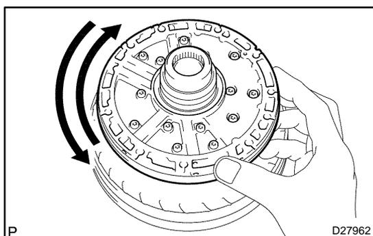
**19. INSPECT OIL PUMP DRIVE GEAR ROTATION**
