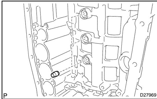
**120. INSTALL BRAKE DRUM GASKET**
