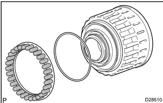
**28. INSTALL REVERSE CLUTCH RETURN SPRING SUB-ASSY**
