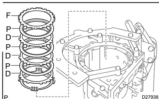
**91. INSTALL BRAKE DISC NO.2**
