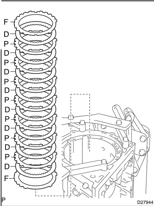
**84. INSTALL BRAKE DISC NO.4**
