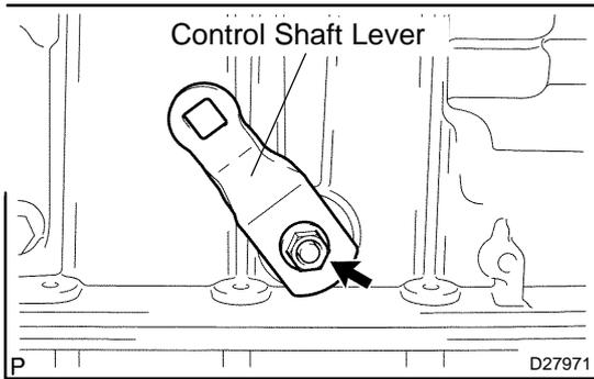
**139. INSTALL TRANSMISSION CONTROL SHAFT LEVER LH (A750# 4RUNNER,GX470)**
