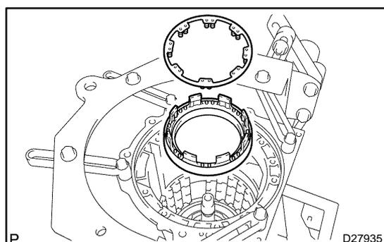
**93. INSTALL BRAKE PISTON RETURN SPRING SUB-ASSY**
