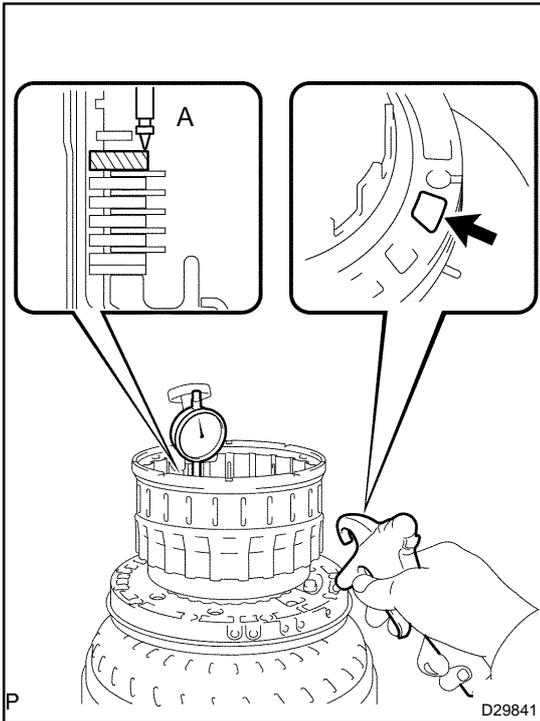
**31. INSPECT PACK CLEARANCE OF DIRECT CLUTCH**
