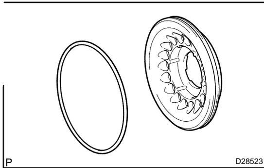
**37. INSTALL CLUTCH BALANCER NO.1**
