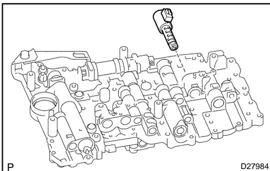
**4. REMOVE SHIFT SOLENOID VALVE SL2**
