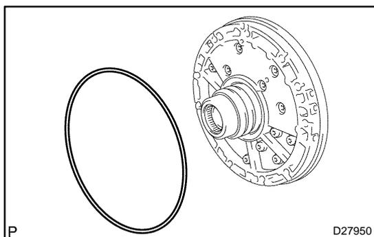
**20. INSTALL FRONT OIL PUMP BODY O-RING**
