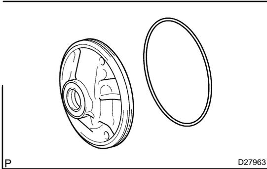
**5. REMOVE FRONT OIL PUMP BODY O-RING**
