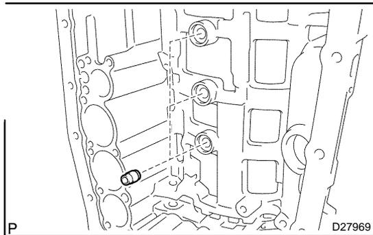
**21. REMOVE BRAKE DRUM GASKET**
