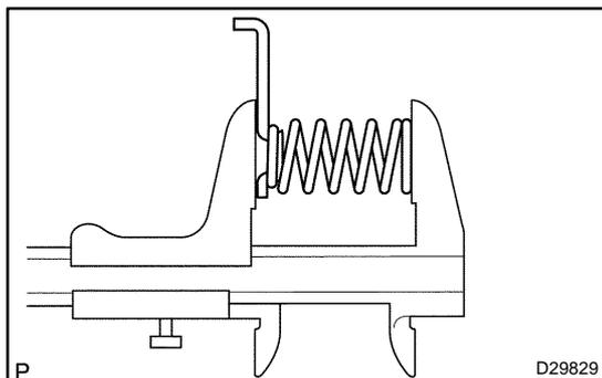
**57. INSPECT BRAKE PISTON RETURN SPRING SUB-ASSYNO.2**
