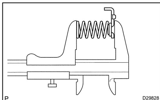
**43. INSPECT BRAKE PISTON RETURN SPRING SUB-ASSYNO.3**
