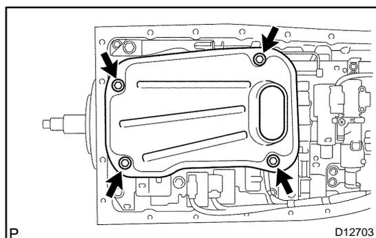
**124. INSTALL VALVE BODY OIL STRAINER ASSY**
