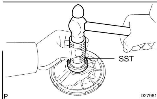
**12. INSTALL FRONT OIL PUMP OIL SEAL**
