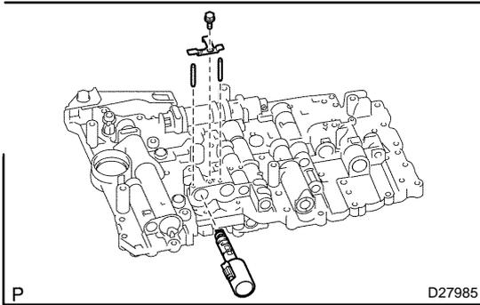
**5. REMOVE SHIFT SOLENOID VALVE SLT**
