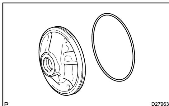
**16. INSTALL FRONT OIL PUMP BODY O-RING**
