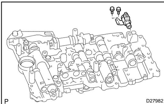
**2. REMOVE SHIFT SOLENOID VALVE SR**
