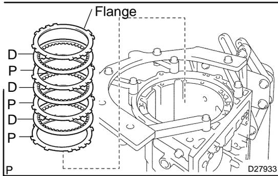
**95. INSTALL BRAKE DISC NO.1**
