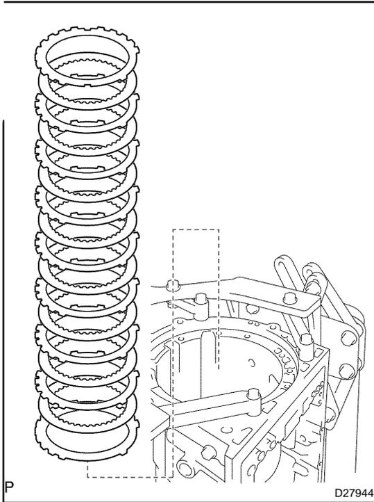
**68. REMOVE BRAKE DISC NO.4**
