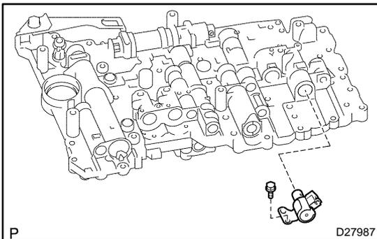
**7. REMOVE SHIFT SOLENOID VALVE S1**
