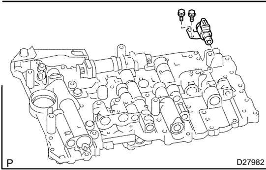
**15. INSTALL SHIFT SOLENOID VALVE SR**
