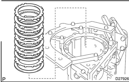
**37. REMOVE BRAKE DISC NO.3**
