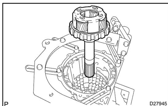
(d) Install the rear planetary gear assy.
