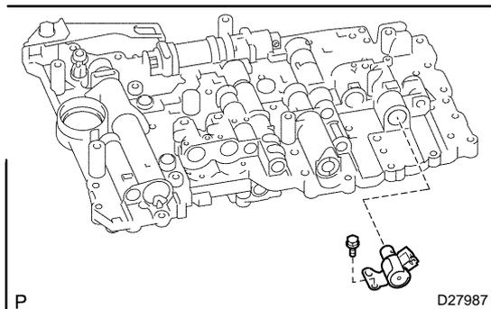
**10. INSTALL SHIFT SOLENOID VALVE S1**
