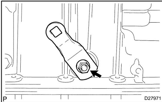
2. **REMOVE TRANSMISSION CONTROL SHAFT LEVER LH (A750# 4RUNNER, GX470)**
