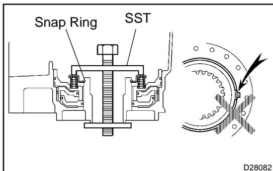
**81. INSTALL 1ST & REVERSE BRAKE RETURN SPRING SUB-ASSY**
