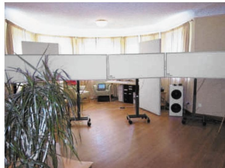
In der Vorführung wurden vier eigens entwickelte experimentelle Distributed Mode Lautsprecher (DML) eingesetzt. Pro Panel (siehe weisse, rechteckige Membran im Bild) können jeweils acht verschiedene Kanäle wiedergegeben werden, in dieser Anordnung also 32 Lautsprecherkanäle. Die grosse Anzahl von Lautsprechern ermöglicht es, anstelle einer Sweet-Spot basierten Wiedergabe einen Ausschnitt eines gesamten Schallfeldes realitätsnah zu simulieren. Dabei erzeugt jeder Lautsprecherkanal nur einen
