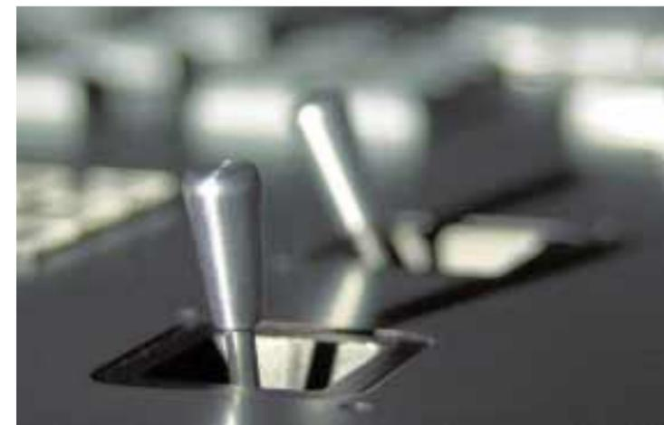
und der separate Divergenz-Regler beeinflusst die Weite des Signals zwischen den beiden Frontlautsprechern. Für Kanäle, deren Signale dynamisch und schnell im Schallfeld bewegt werden müssen, kann zudem ein (optionaler) Joystick zugeordnet werden. Üblicherweise stehen im Studer 980 zwei Joysticks zur Verfügung; es dürfen aber auch weniger oder mehr sein.
