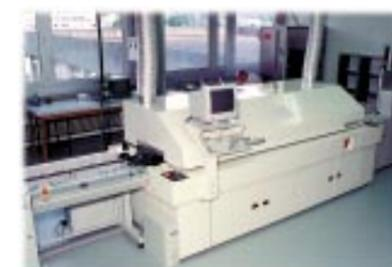
SMD heisst ein neues Bestückungs- und Lötverfahren, bei dem die Bauteile nicht in die Printplatte eingesteckt, sondern auf die Oberfläche erst geklebt und dann verlötet werden. Dieses Verfahren ermöglicht eine wesentlich höhere Packungsdichte und Zuverlässigkeit.
