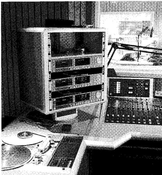
In dem gesamten Regie- und Sendebereich wurde eine von STUDER Deutschland entwickelte Kommandoanlage eingesetzt. Diese soll die Kommunikation zwischen Sendeleitung, Moderator und Regie komfortabel (Prioritätsebenen, Besetztsignalisation, Rufspeicherung, Integration in vorhandene Regiepulte) sicherstellen. Einige dieser Sprechstellen wurden um ein kundenspezifisch ausgelegtes Abhörfeld erweitert, das auf der Technologie des STUDER Regietischs 990 aufbaut.
