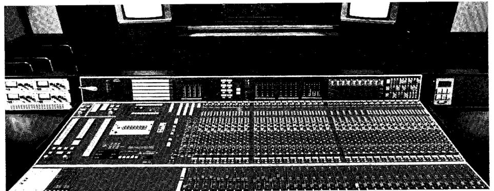
STUDER Tonregietisch 904 mit VCA-Reglern und eingebautem System Controller SC 4016.
