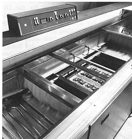
4 Bürsten-Reinigungsmaschinen mit Kühlstationen im Ein- und Auslauf
