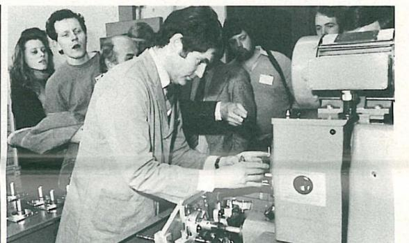
Wickelmotorflanschen in Bearbeitung auf der Honma-Maschine mit automatischer Messsteuerung. Martin Flühmann am Innenmessgerät.
