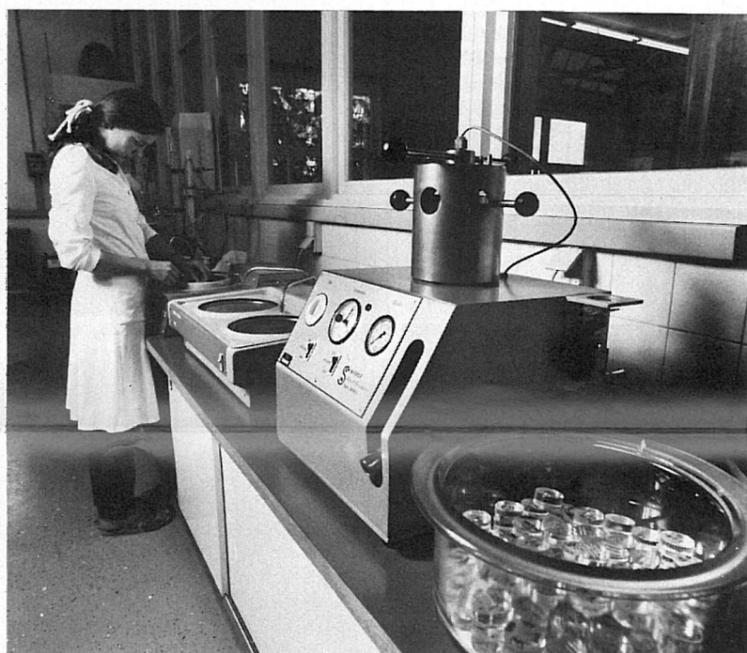
21. Im Chemielabor werden neben Analysen auch täglich Schliffbilder hergestellt. Im Vordergrund die Wärmepresse für das Eingiessen der Schliffproben.
