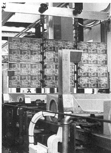
14. ...wird von der Transporteinrichtung automatisch verschoben und exakt nach dem Programm der Mikroprozessorsteuerung über der nächsten Station positioniert.
