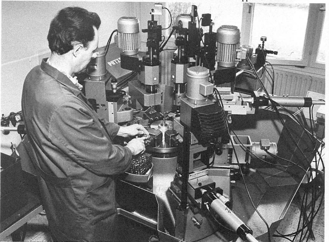
12. Nur das Einlegen der Teile geschieht noch von Hand. Alle Bearbeitungsvorgänge erfolgen automatisch und mit höchster Präzision.
