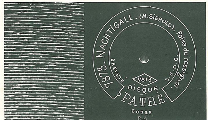
4. Pathé Platte in Tiefschrift. Abtastung mittels Saphierkugel auf der Nadel. Aufzeichnung von Innen nach Aussen. 80 – 110 U/min. bei Durchmessern von 23 – 43 cm (eine 43 Platte wog 4 kg)
