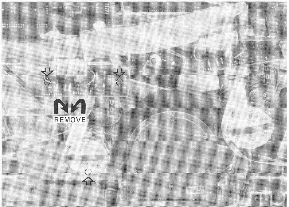
Fig. 53 Bandlaufaggregat ausbauen
