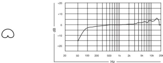
FIGURE 2. TYPICAL CARDIOID FREQUENCY RESPONSE
