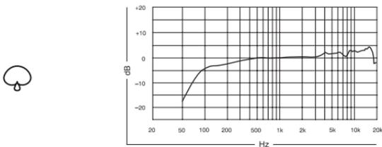
FIGURE 4. TYPICAL SUPERCARDIOID FREQUENCY RESPONSE
