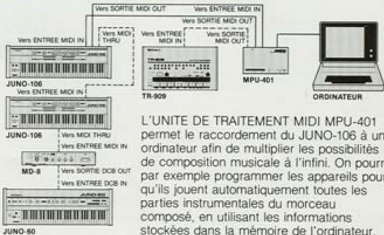
L'UNITÉ DE TRAITEMENT MIDI MPU-401 permet le raccordement du JUNO-106 à un ordinateur afin de multiplier les possibilités de composition musicale à l'infini. On pourra par exemple programmer les appareils pour qu'ils jouent automatiquement toutes les parties instrumentales du morceau composé, en utilisant les informations stockées dans la mémoire de l'ordinateur.
