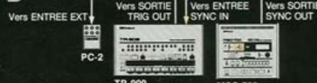
Les données du MSQ-700 sont synchronisées avec la TR-909. Il est aussi possible de contrôler des sources sonores extérieures, le synthétiseur de percussion PC-2 par exemple, en utilisant le signal déclencheur (rim shot) de la TR-909.
