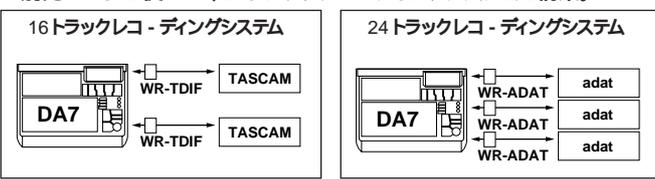
WR-TNDMを使用してWR-DA7を2台カスケード接続。32トラックへ拡張可能。
