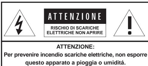
Il simbolo del fulmine in un triangolo equilatero vuole avvertire della presenza di tensioni elevate non isolate e di valore sufficiente per costituire rischio di shock elettrico alle persone.
