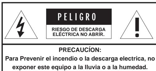
El símbolo de flecha relámpago dentro de un triángulo equilátero, es para alertar al usuario de la presencia de "voltajes peligrosos" no aislados en el interior del aparato, los cuales pueden ser de suficiente magnitud para constituir un riesgo de choque eléctrico a las personas.
