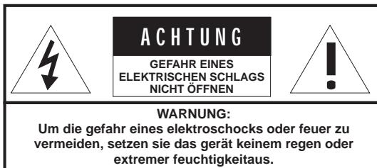
Der Blitz mit dem Pfeil, in einem gleichschenkligen Dreieck, soll den Benutzer vor unisoliertem „gefährlichen Spannung“ innerhalb des Gerätes warnen.
