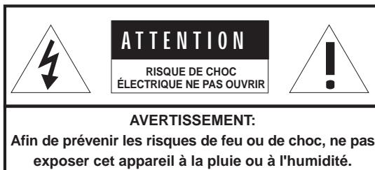
La lumière clignotante du symbole de la flèche à l'intérieur d'un triangle équilatéral, à pour objet d'alerter l'utilisateur de la présence "d'un voltage dangereux" non-isolé à l'intérieur du produit, qui pourrait être de magnitude suffisante au risque d'électrocution.
